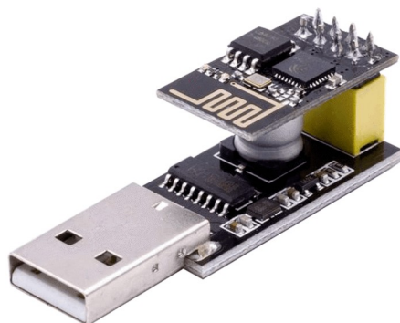
Adaptador USB con ESP8266-01S:
